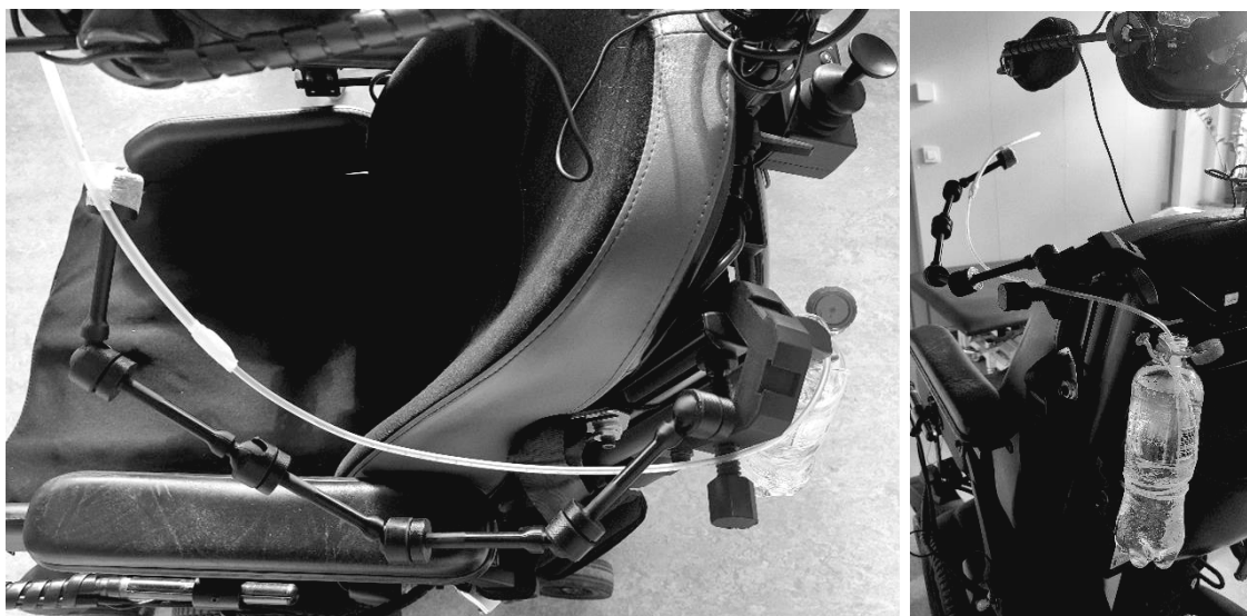
Sliki 3 in 4: 3D natisnjen pripomoček za pitje vode, uporabljen na invalidskem vozičku
